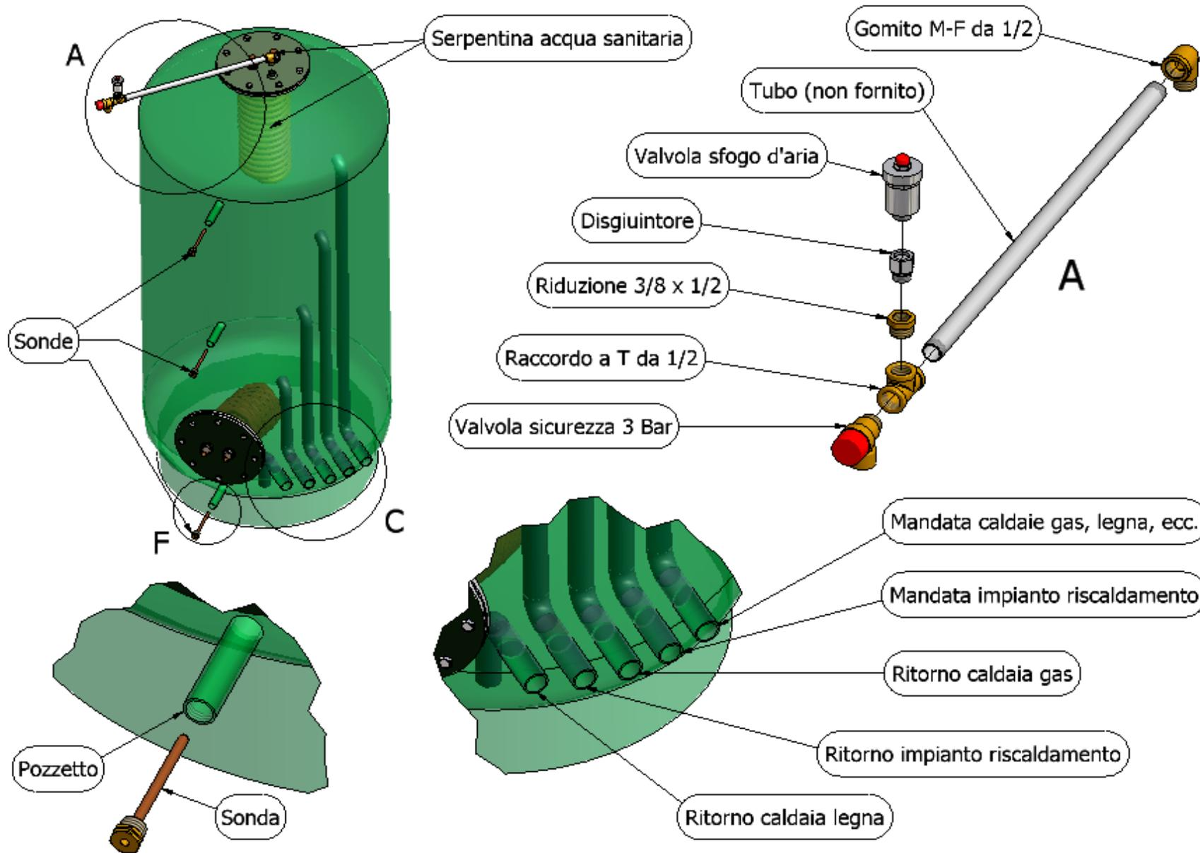
NB: I tubi acqua fredda e calda devono essere collegati ASSOLUTAMENTE sotto la copertura superiore del disco in poliuretano e devono uscire lateralmente. È VIETATO FORARE IL DISCO IN POLIURETANO !!
